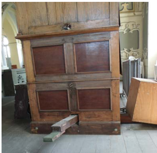
Figura 10: Alavanca do fole e motor do órgão da Catedral de Aracaju
