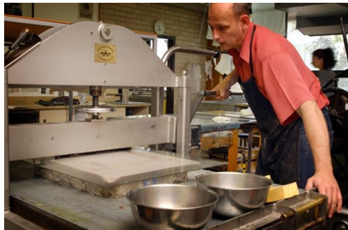
Fig. 10 – Prensa (manual) litográfica sendo preparada para impressão.
