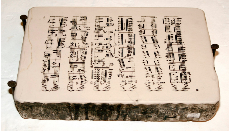
Fig. 9 – Pedra litográfica com partitura desenhada (matriz reprodutora da imagem).
