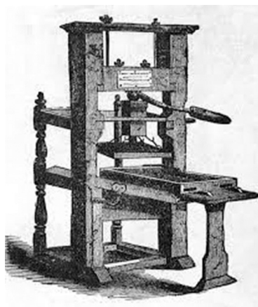
Fig. 2 – Prensa de Pancada ou prensa de Gutenberg, criada no ano de 1447 pelo alemão Johann Gutenberg.
