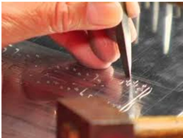
Fig. 4 – Artista ou artesão trabalhando a criação em baixo relevo utilizando-se da técnica da punção.
