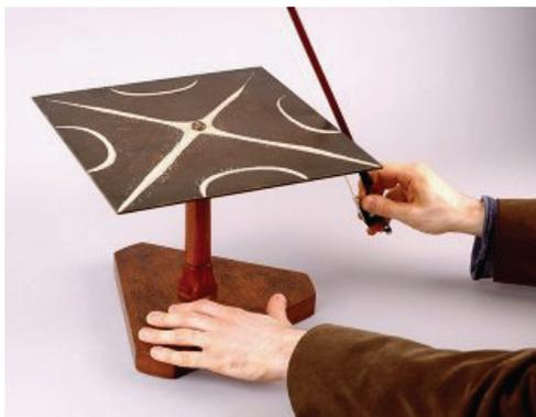
**Figura 1** – Padrão sobre prato de Chladni produzido com arco de violino. Fonte: <http://www.sites.hps.cam.ac.uk/whipple/explore/acoustics/ernstchladni/>
