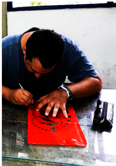
Figura 20: Processo de gravação no molde vasado.
